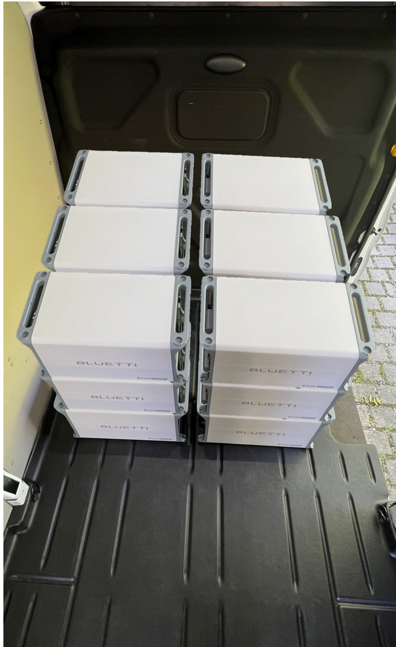
Darstellung: 80 kWh System (2x EP760 Inverter, 16x B500 Batterie)
